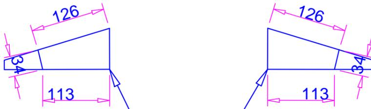
Tracer et couper les deux chutes de la toiture pour réaliser les cotés du auvent
